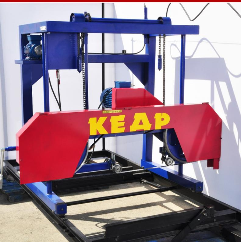
Ленточные пилоары КЕДР подразделяются на 2 категории по диаметру обрабатываемых брёвен: все пилоары с литерой М предназначены для работ с брёвнами диаметром до 730мм, пилоары БЕЗ литеры М - для работы с брёвнами, диаметром до 1000мм.
