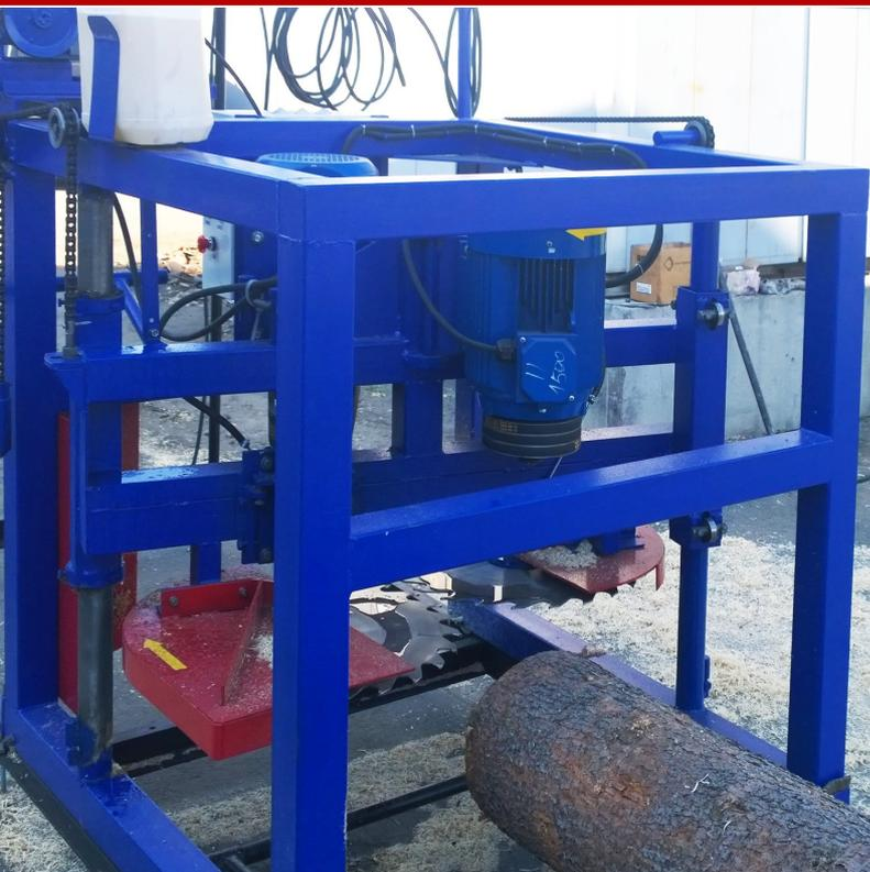
«КЕДР ДП-2» - дисковая пилорама, предназначенная для продольной распиловки брёвен.
