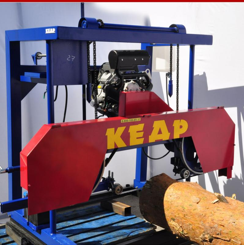
Ленточная пилорама «КЕДР-4Д» - это модель с дизельным двигателем мощностью в 9.6 лошадиных сил. Продуктивность станка - от 5 до 12 кубических метров пиломатериала за 8ми часовую смену. Пилорама способна работать и в две, и в три смены без нарушения параметров износостойкости.
