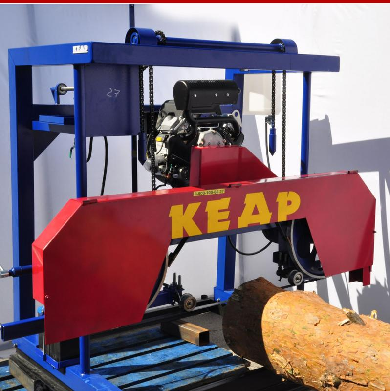
Пилорама «КЕДР-4Б» оснащена проверенным годами надежной работы в различных погодных условиях двигателем Subaru мощностью 22 л.с. Такая конструкция станка позволяет значительно повысить его производительность. Независимо от того, где вы планируете поместить оборудование, можете быть уверены на 100% в стабильности и бесперебойности работы техники. Она продолжает эффективно работать даже в сильный мороз. Оборудование имеет крепкий каркас, который выдержит самые серьезные нагрузки.
